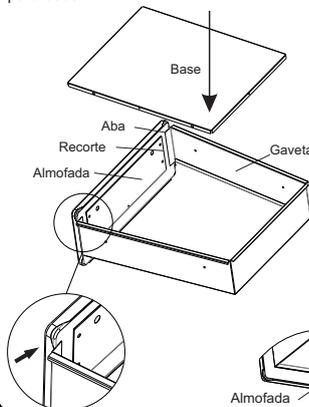
III) Fixe os parafusos A (3,5x9,5) na almofada, travando a gaveta. Utilize o parafuso B (3,5x9,5) para fixar a base na almofada. Encaixe a bucha branca e os parafusos C (3,5x9,5) juntos, no furo da almofada. Posicione o puxador e aperte os parafusos. Posicione o trilho menor, alinhando-o sobre os furos da lateral da gaveta. Utilize os parafusos D (M4x6) e as porcas M4 para fixar.
