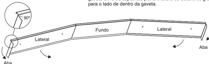
II) Encaixe as abas da gaveta no recorte existente na almofada. Em seguida, encaixe a base na gaveta, de cima para baixo, antes de fixar os parafusos.
